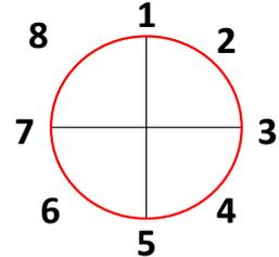
**MEDICIÓN DE ESPEORES POR ULTRASONIDO EN: mm**
